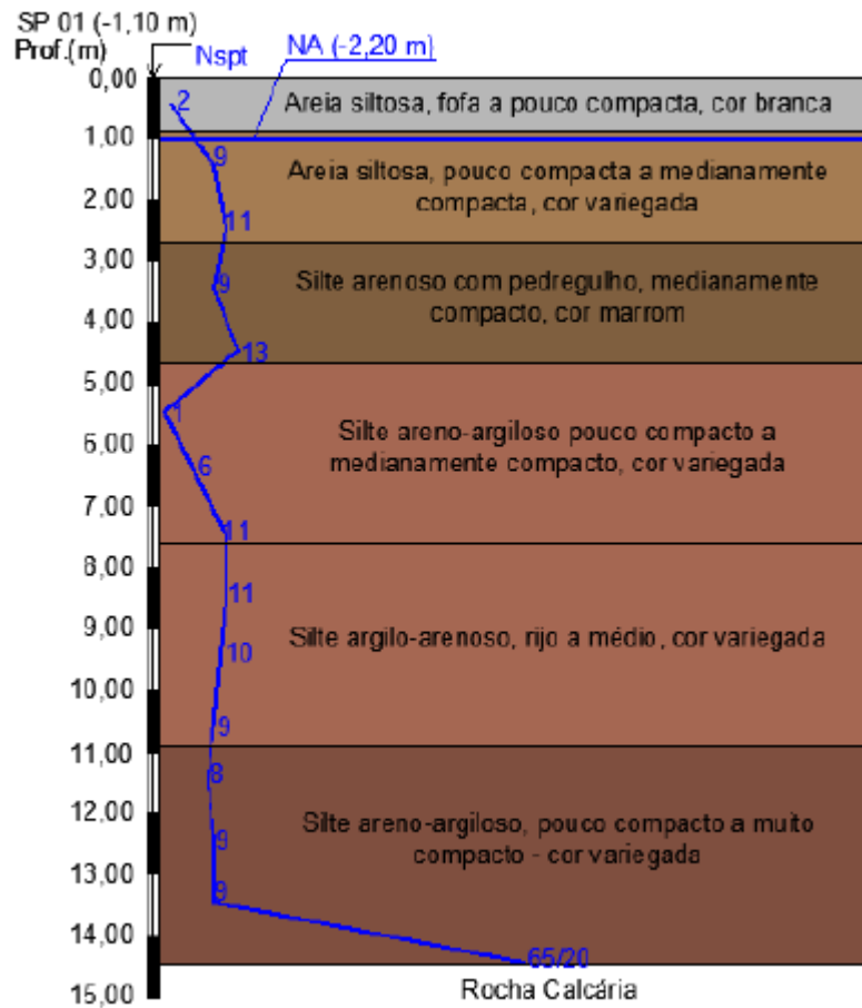
Figura 4. Perfil Geotécnico individual do SP-01.
