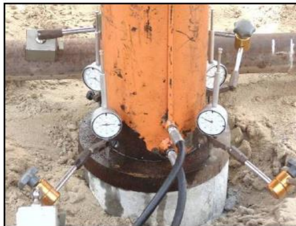
Figura 11: Disposição dos extensômetros na estaca teste.
