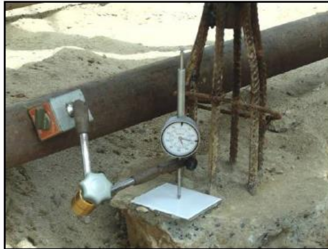
Figura 12: Disposição dos extensômetros nas estacas de reação.
