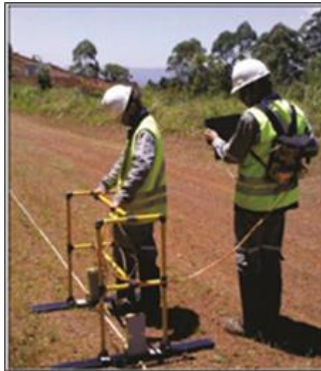
Figura 2: Levantamento GPR em campo.
