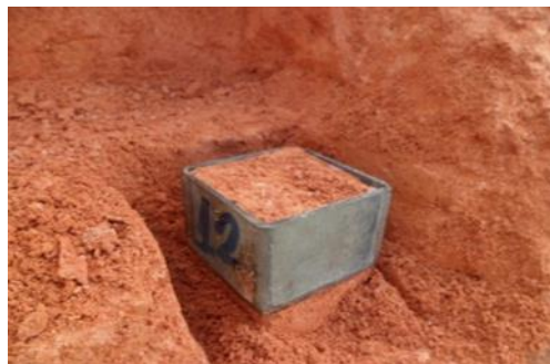
Figura 6. Escavação para obtenção de amostragem indeformada.
