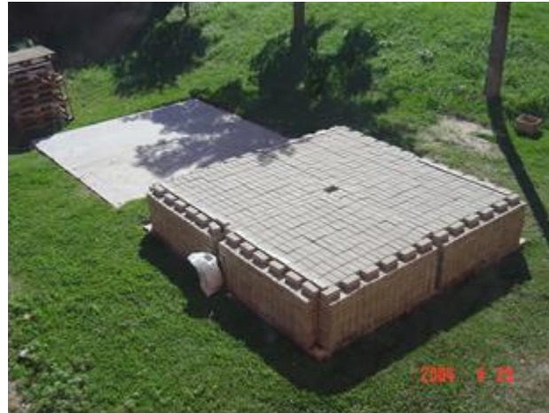
Figura 1. Radier com carregamento de 14,71 kPa.
