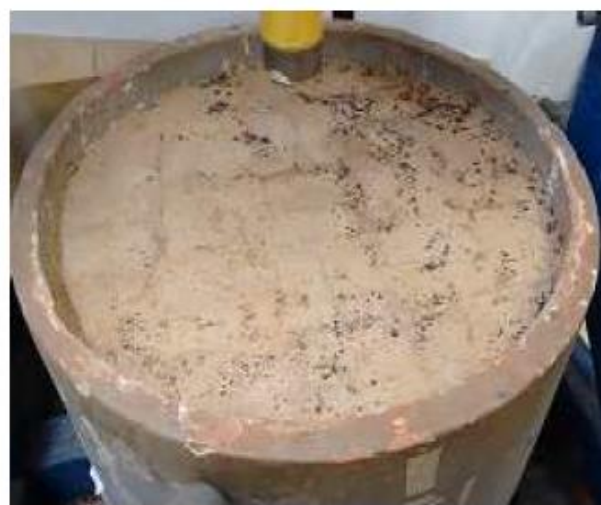
Figura 12. Camada de assentamento da estrutura saturada com reforço (registro feito após o ensaio).
