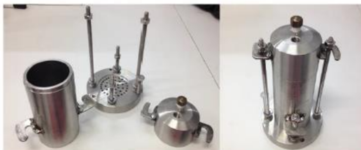
Figura 1. Célula de compactação utilizada para síntese da rocha carbonática
