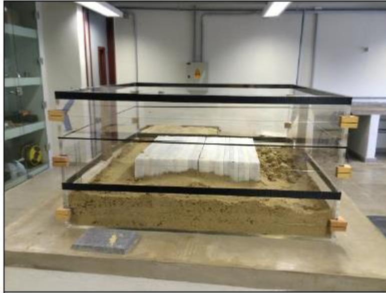
Figura 6: Tanque de acrílico preenchido com areia. O modelo reduzido se encontra enterrado no tanque. Atenção aos reforços nas paredes da caixa.
