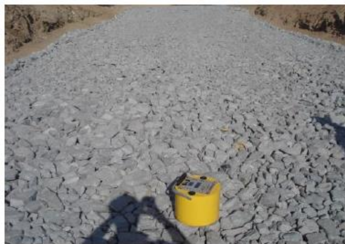
Figura 4. Aparelho GeoGauge em uso no eixo da via.
