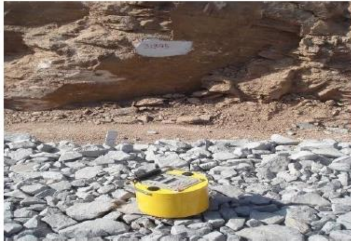
Figura 2. Aparelho GeoGauge em uso no bordo direito.
