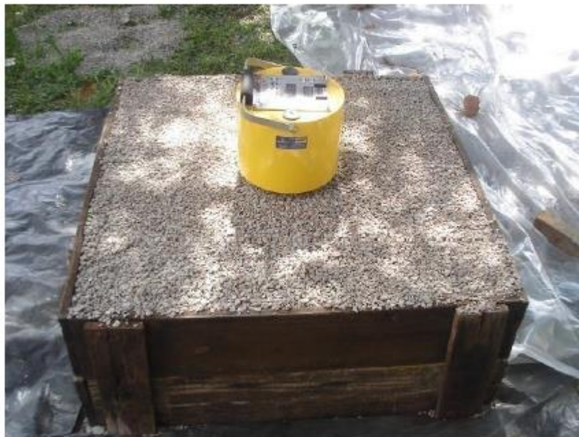
Figura 15. Ensaio com o Geogauge H4140 com brita 0.
