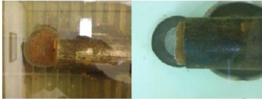
Figura 6. Ensaio de Perda de massa por imersão. À esquerda do solo; direita da mistura solo+RCD.
