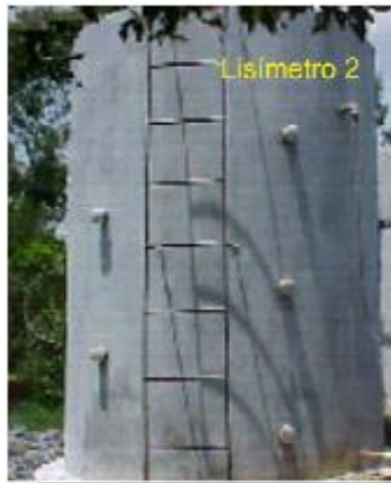
Figura 4. Reator experimental instalado na Muribeca-PE - Lisímetro.
