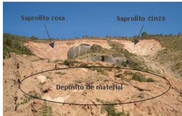
Figura 3 - Tipos de solo residual derivados do granito encontrados na encosta
