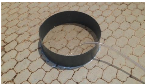
Figura 13. Ensaio de permeabilidade em pisos intertravado.
