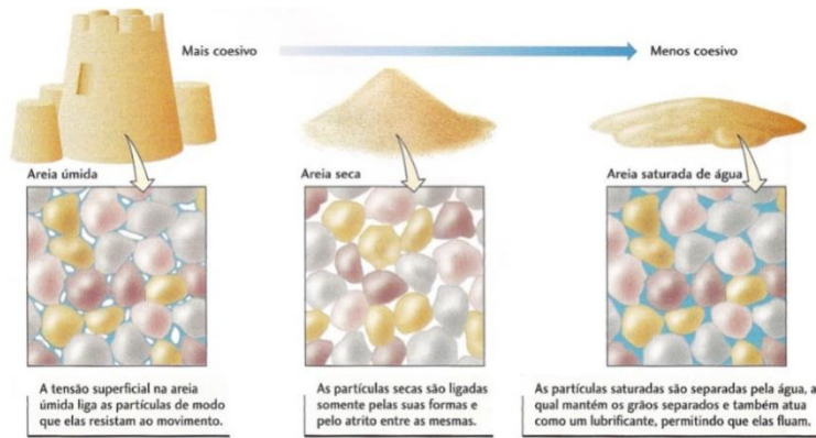
Figura7: Poro pressões negativas, nulas e positivas respectivamente nos interstícios entre as partículas. [8]
