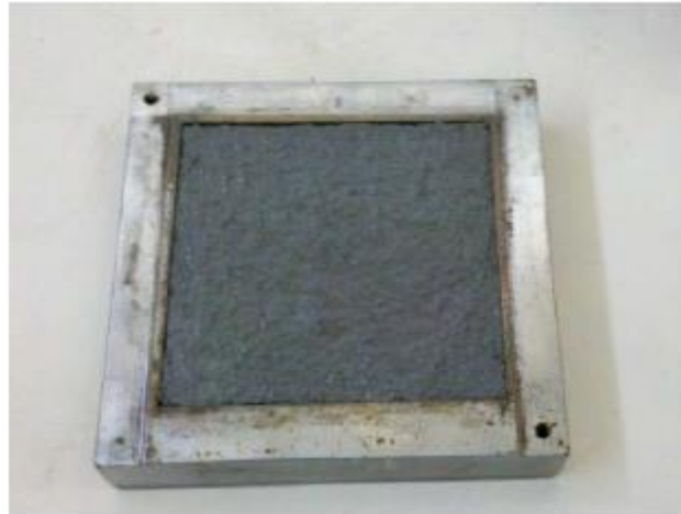
Figura 10 – Superfície de concreto na câmara de cisalhamento.
