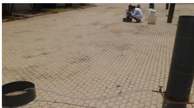
Figura 14. Ensaio de permeabilidade em pisos intertravado.
