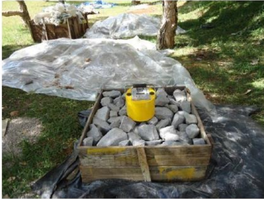
Figura 14. Ensaio com o Geogauge H4140 com rachão.
