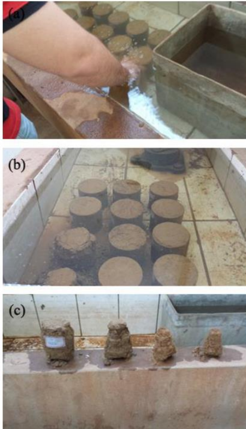
Figura 8. (a) Instante da imersão dos corpos de prova em água; (b) desinstegração parcial dos corpos de prova; (c) corpos de prova após a imersão.
