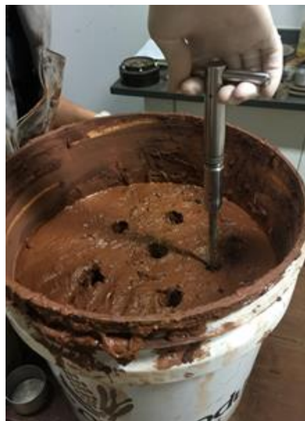
Figura 9. Execução do ensaio de Mini Vane.
