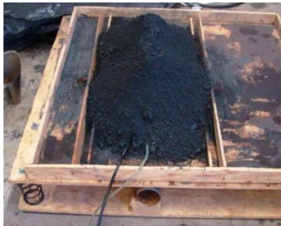
Figura12: Modelo reduzido de uma pilha de estocagem de estocagem de minério de ferro.
