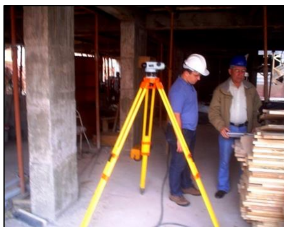
Figura 5. Nível Óptico Zeiss Ni 40 utilizado durante o levantamento (Fonte: Autor, jan./2011).
