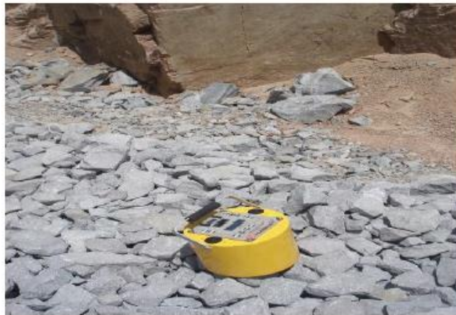
Figura 3. Aparelho Geogauge em uso no bordo esquerdo.
