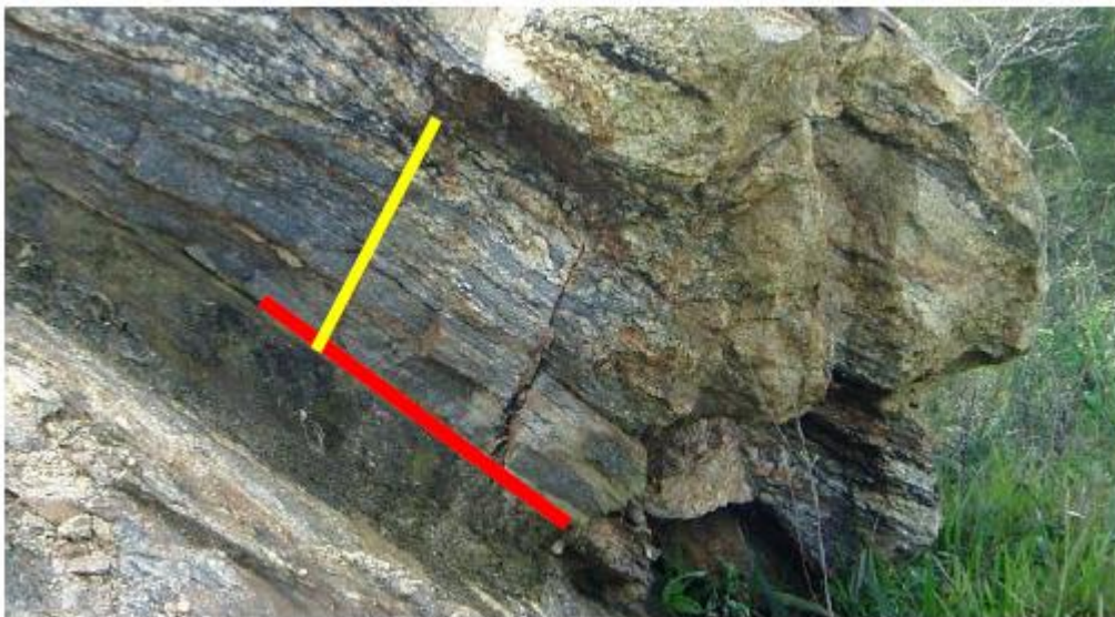
Figura 6 – Associação entre o sistema de juntas e a foliação.
