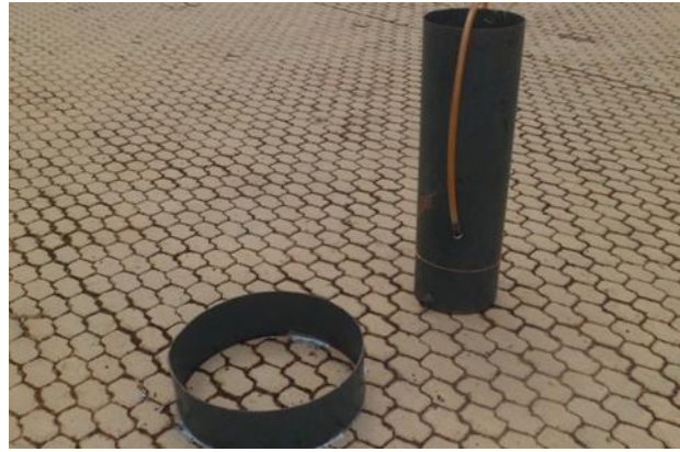
Figura 15. Ensaio de permeabilidade em pisos intertravado.
