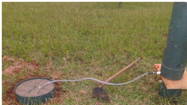
Figura 11. Ensaio de permeabilidade em pisos intertravado.
