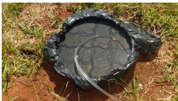
Figura 12. Ensaio de permeabilidade em pisos intertravado.
