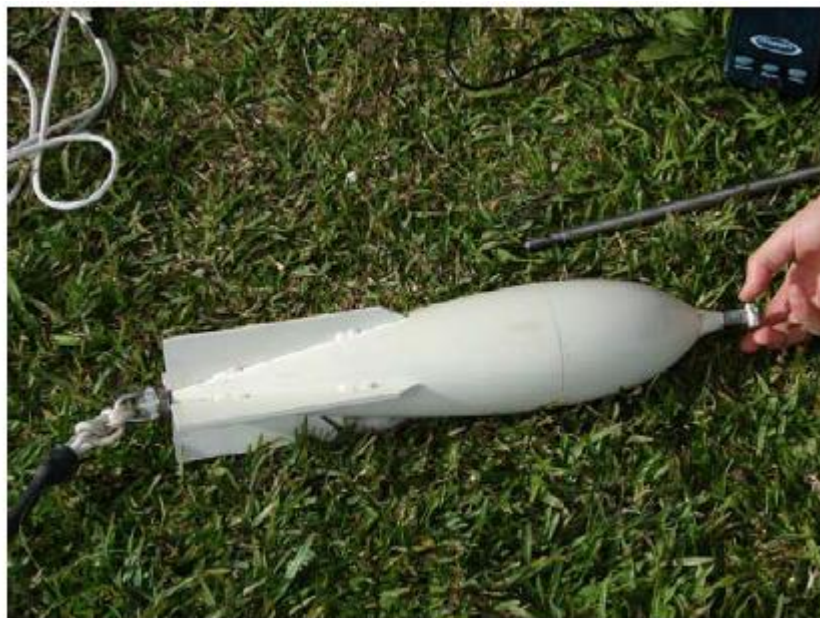
Figura 6. Corpo do penetrômetro pintado e com cabos de dados e de recuperação conectados.
