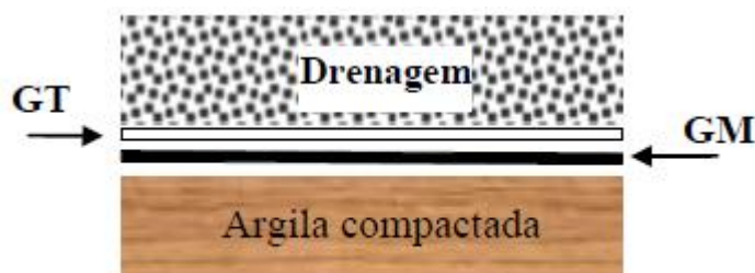
Figura 1. Configuração típica de barreiras impermeabilizantes: GM-geomembrana; GT (geotêxtil) (modificado de KOERNER, 1998).
