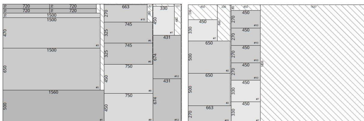
Figura 7 – Padrão de corte não orientado gerado pelo FFDH direcionado por largura
