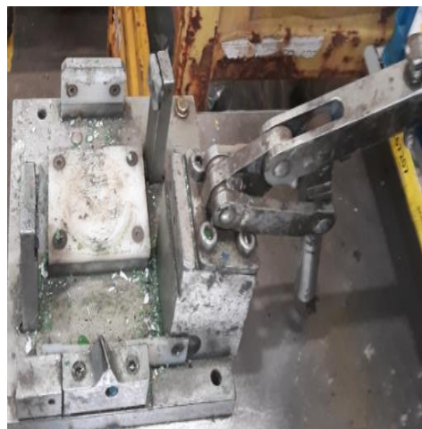
Figura 8 – Dispositivo com base em formato U
