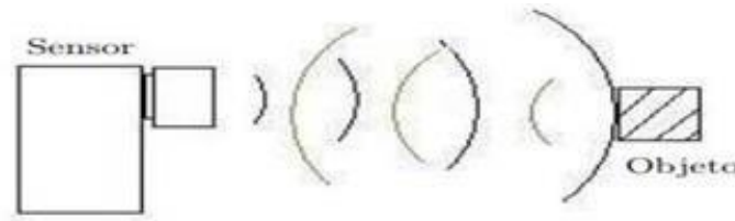
Figura 3 - Transmissão e reflexão da onda ultrassônica
