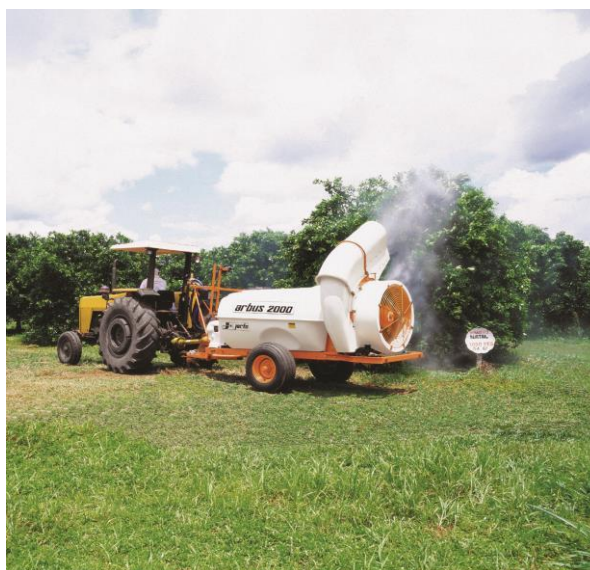
Figura 8: Pulverizador para culturas arbórea de grande alcance
