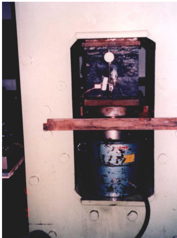
Foto 3 - Pórtico de reação utilizado para a ruptura dos corpos-de-prova de maior porte - Detalhe de espécie em cúbico com lado igual a 31,1cm, instrumentado para a medição de deformações (CIENTEC, 1996).
