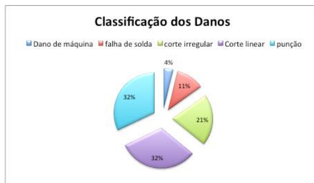
Figura 5. Classificação e percentual de ocorrência dos principais danos encontrados na geomembrana das áreas inspecionadas pelo Soil Survey.
