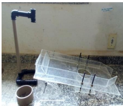
Figura 1. Aparelho de Inderbitzen. Itens: A: Suporte para mangueira de alimentação; B: Molde padrão; C: Base com angulação ajustável; D: Rampa do aparelho; E: Placa de regulagem de vazão e altura da lâmina de água; F: Suporte para o molde.
