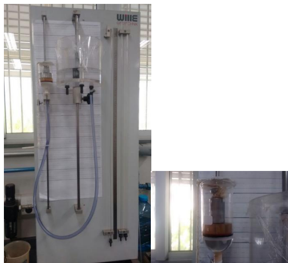
Figura 6 – Ensaio de coluna suspensa montado no LabGeo UFMG e em detalhe o funil de Büchner.
