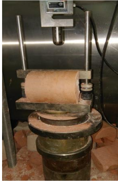
Figura 8: Rompimento de corpo de prova submetido ao ensaio de Resistência à Tração por compressão diametral.
