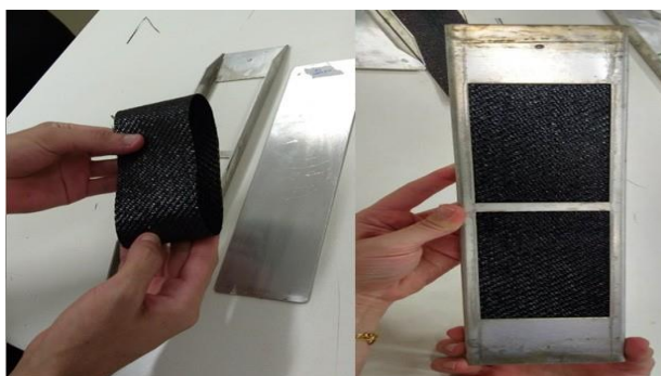
Figura 3. Fixação dos corpos-de-prova nos suportes para ensaios de intemperismo acelerado.
