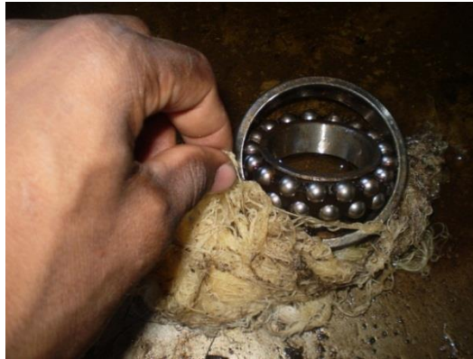
Figura 14 – Mecânico efetuando a limpeza de um rolamento de forma inadequada.
