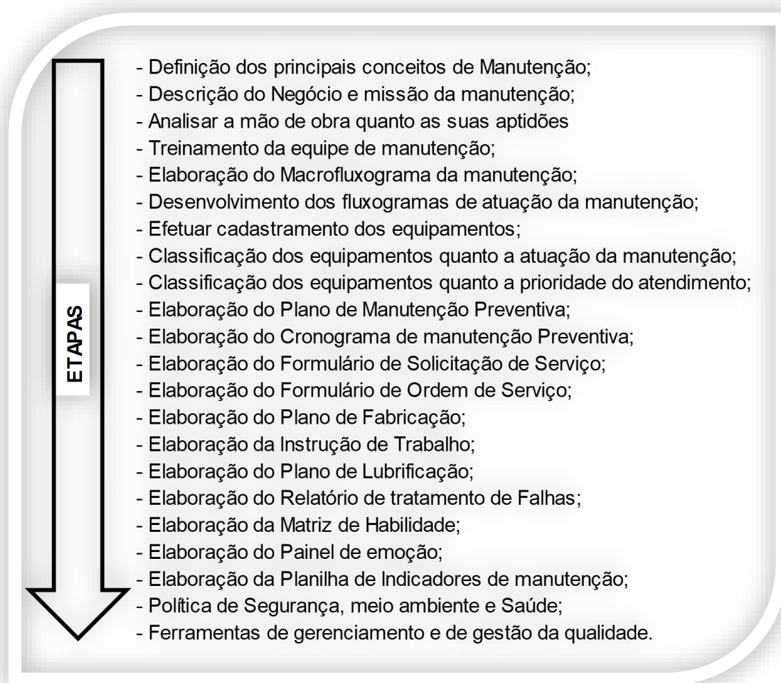
Figura 20 – Etapas de Implementação do Modelo Sistemático do Planejamento de Manutenção.
